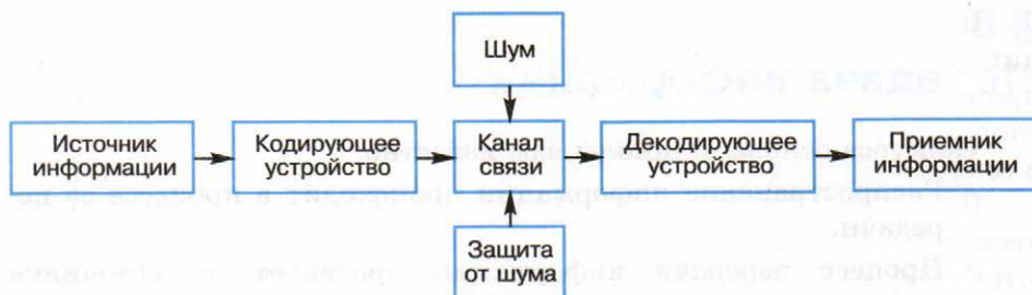
Рис. 2.1. Модель передачи информации по техническим каналам связи
